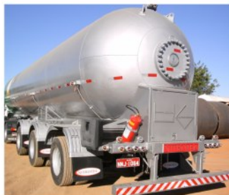
Semi reboque para transporte de GLP e Amônia 62 m³
