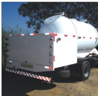
Caminhão tanque para transporte de GLP 6,5 @ 23 m³ e Amônia
