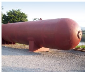
Tanques de estocagem de GLP e Amônia horizontais e verticais
