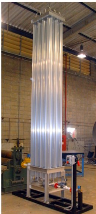
Vaporizador atmosférico contribui para a preservação dos recursos naturais
